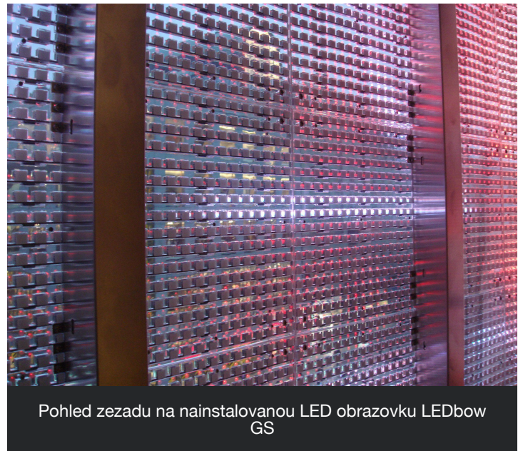
Při svítících plochách průhlednost neruší a LEDbow GS se chová jako jakákoli jiná LED obrazovka
